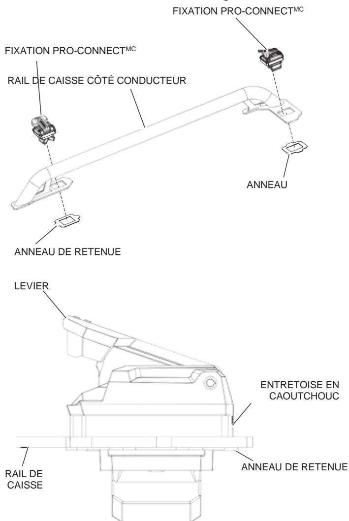
3. Retirez la pellicule des bandes autoadhésives en caoutchouc et collez-les au rail de caisse côté conducteur dans la position illustrée ci-dessous.
