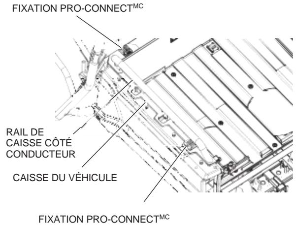
5. Répétez les étapes 1 à 4 pour le rail de caisse côté passager. Pour retirer le rail de caisse du véhicule, soulevez le levier de chaque fixation Pro-Connect<sup>MC</sup> et soulevez l'accessoire pour le retirer.
