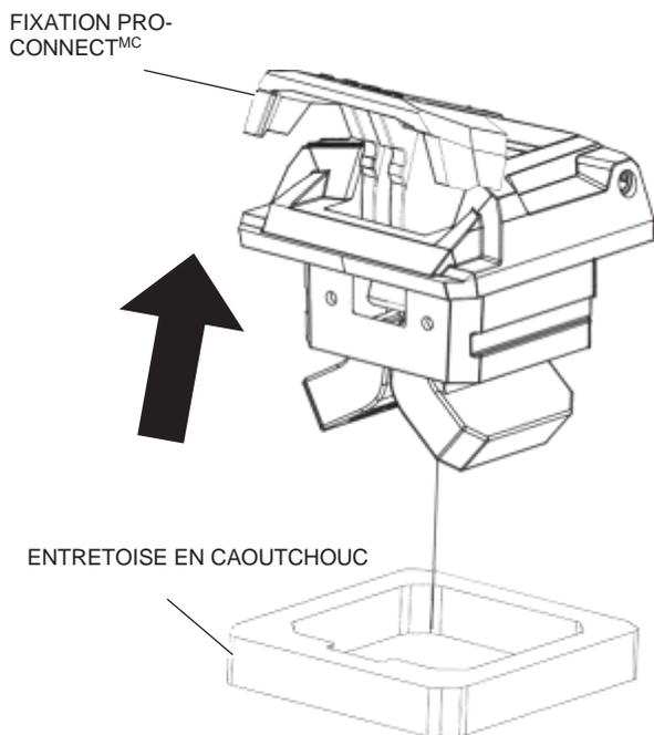
2. Insérez les fixations Pro-Connect<sup>MC</sup> assemblées avec les entretoises en caoutchouc dans les orifices d'installation carrés des rails de caisse côté conducteur et sécurisez-les en utilisant les anneaux de retenue.
