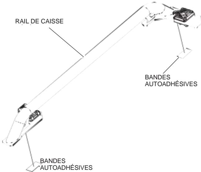
4. Assurez-vous que les leviers des fixations Pro-Connect<sup>MC</sup> sont en position ouverte, puis placez le rail de caisse côté conducteur sur la caisse du véhicule en alignant chaque fixation Pro-Connect<sup>MC</sup> avec l'orifice d'installation correspondant de la caisse. Verrouillez le rail de caisse en place en appuyant sur les deux leviers de fixation Pro-Connect<sup>MC</sup>.
